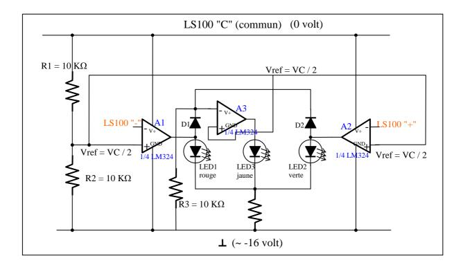
Une solution consiste à inverser électroniquement les signaux de commandes LS100 "+" et LS100 "-". Cette inversion est effectuée par les deux amplis opérationnels A1 et A2, de type LM324. Le LM324 se présente en boitier DIL14, et les 3 amplis utilisés dans ce schéma, pour piloter un signal, sont donc situés dans un boitier unique.
